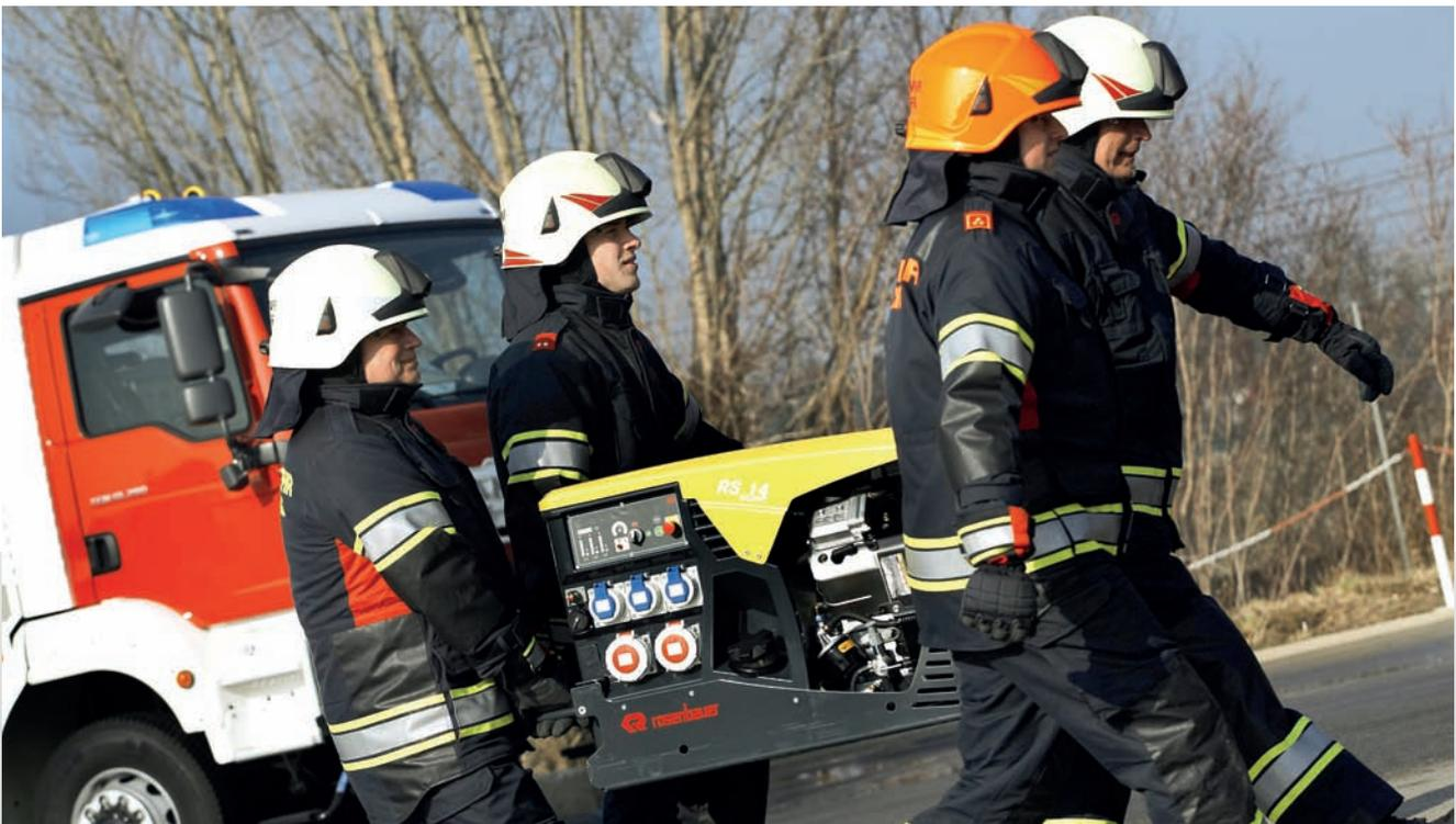
Alle RS 14 und RS 14 SUPER SILENT sind standardmäßig mit einer Schnittstelle zur Batterieladeerhaltung des Stromerzeugers ausgestattet. Natürlich ist auch eine CAN-BUS Anbindung an entsprechende Fahrzeuge möglich. Damit kann der Stromerzeuger jederzeit fernüberwacht, gestartet und gestoppt werden. Die Fernüberwachung\* / Fernstart-Stop wird als Option angeboten.
