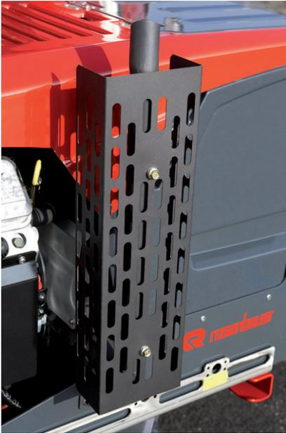
Abgasdeflektor\* zur Abgasabführung nach oben bei Drehleitern.
