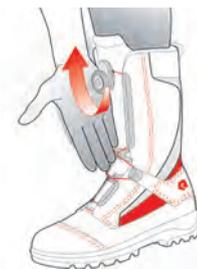
4. Druck-Drehknopf mit der Handkante zudrehen, bis der Stiefel optimal sitzt!
